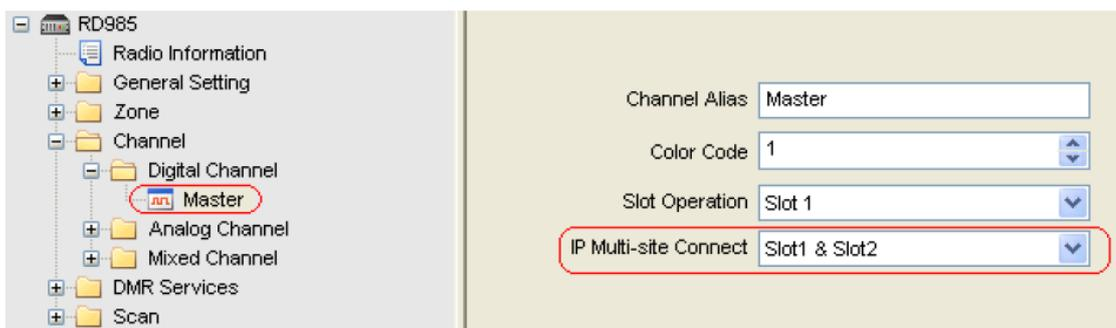
Рисунок 5.2.3-3 Установка слота для IP Multi-site Connect на ретрансляторе Master
