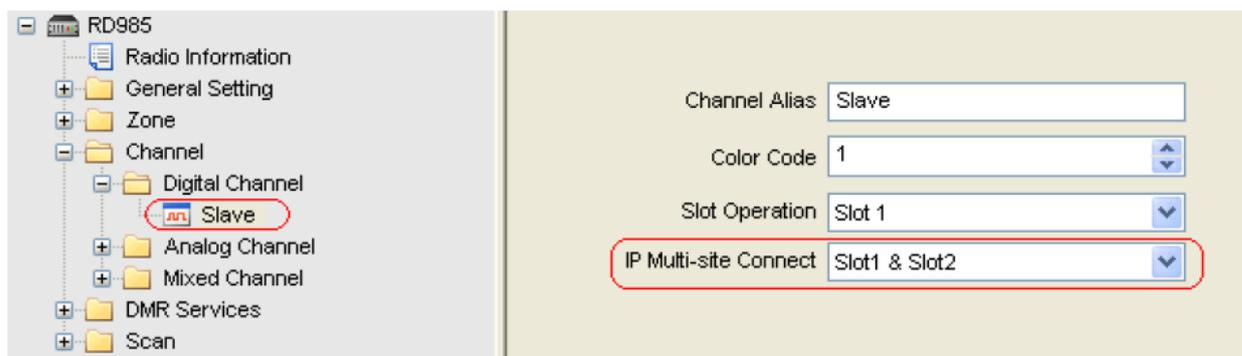
Рисунок 5.2.3-6 Установка слота для IP Multi-site Connect на ретрансляторе Slave
