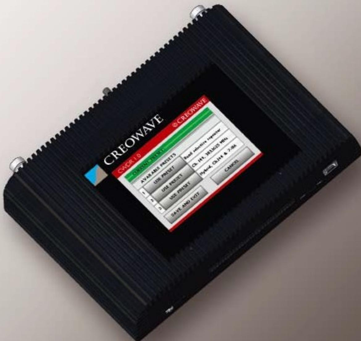
Революционный Гибридный Ретранслятор TETRA для улучшения покрытия
